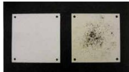
A la izquierda la placa recubierta con GAINA a la derecha recubrimiento acrílico.
